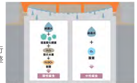
▲結露は外気温(左の表)と管路内(蓋の裏)の気温差によって発生しやすい塗膜に傷やはがれがあるとより腐食が進行する
